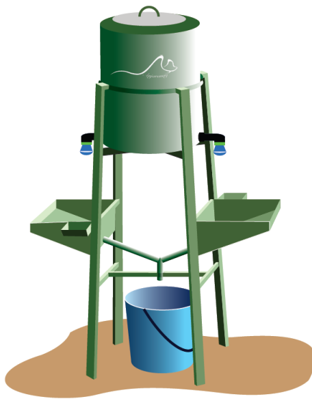
Fig.41 Prototype du lave-main mis en place par Anjaranay dans les écoles de Sainte-Marie
